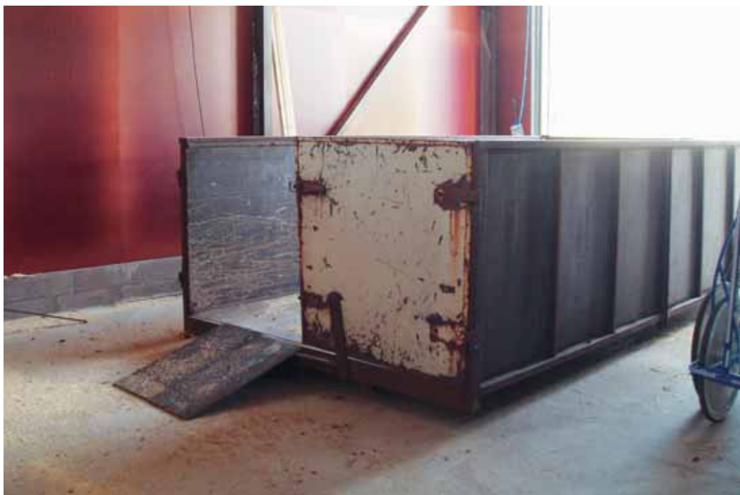
Kuva 11. Hyvä vaihtoehto vaihtolavan sijoittamiselle on katettu tila, jossa on tiivis pohja.
